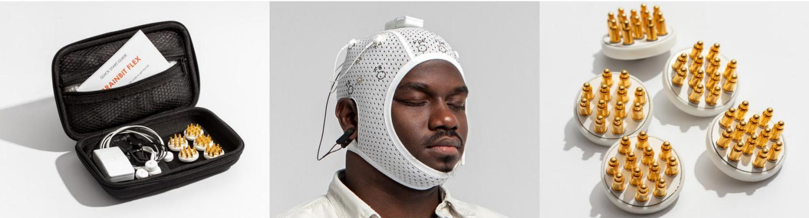
BrainBit Flex ist eine tragbare 4-Kanal-EEG-Neuralschnittstelle mit freier Elektrodenpositionierung, die eine genaue und zuverlässige Registrierung der elektrischen Aktivität des Gehirns ermöglicht. Das einzigartige und praktische Elektrodenfixierungssystem macht die Sitzung einfach und abwechslungsreich. Sie können genau die Punkte und Biorhythmen des Gehirns studieren, die für Sie von Interesse sind.
